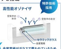
金属電極がガラスで覆われているため、 空気中の湿度の影響を受けにくく 安定した効果を発揮。 POINT-02
